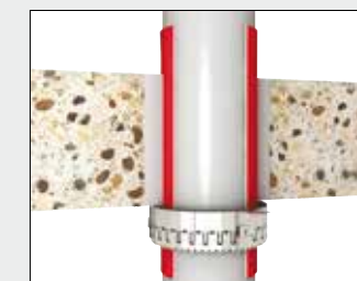
Montaż w stropach o grubości \geq 150 mm
