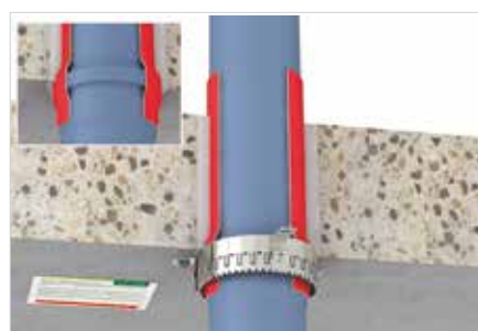
Montaż na kielichach rur.
