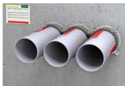
Kilka rur obok siebie (możliwe zastosowanie jednej opaski dla max. 3 rur). Odległość pomiędzy rurami ≤ 15 mm.
