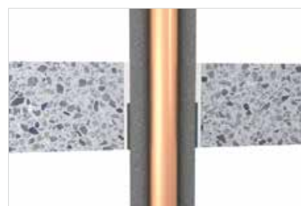
Rury niepalne z izolacją, opaska wewnątrz stropu.
