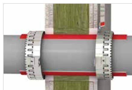
Ściany blaszane wypełnione wełną mineralną, wypełnienie szczeliny pomiędzy ścianą a rurą BIS Pacifyre® FPM Zaprawa ogniochronna.
