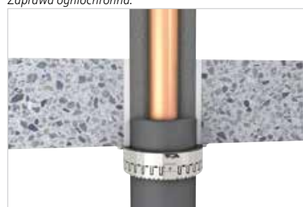
Rury niepalne z izolacją, opaska pod stropem.
